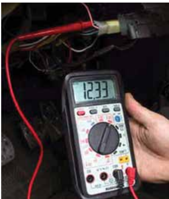
شکل ۲۸-۱۱ اندازه‌گیری ولتاژ در ترمینال ورودی سوئیچ
