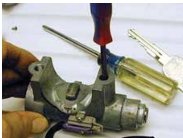
شکل ۱۸-۱۱- باز کردن پیچ مغزی سوئیچ
