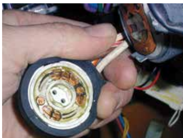
شکل ۱۱-۱۴- ترمینال داخل فیبری سوئیچ
