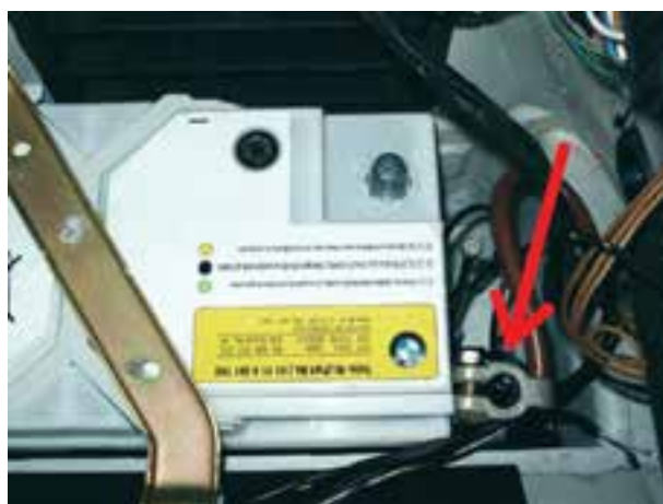
شکل ۹-۱۱- باز کردن کابل اتصال بدنه ی باتری
