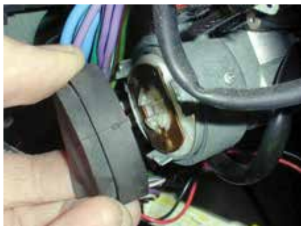
شکل ۱۱-۱۳- بیرون آوردن فیبری پشت سوئیچ
