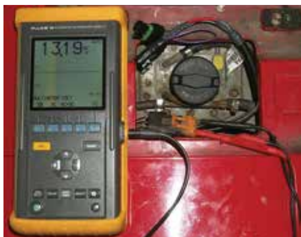
شکل ۸-۴۶- اندازه‌گیری ولتاژ مدار
