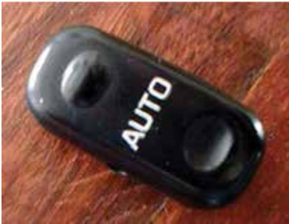
شکل ۱۴۶-۲- شستی سوئیچ شیشه بالابر
