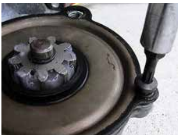
شکل ۱۳۱-۲- بستن پیچ های درپوش به بدنه
