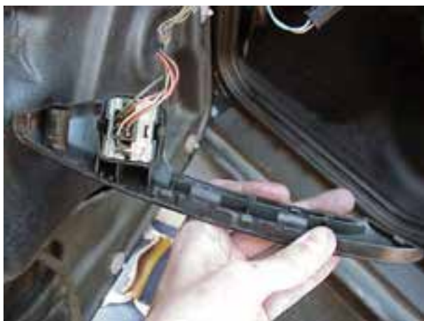
شکل ۱۱۸-۲- اتصال سوکت سوئیچ شیشه بالابر
