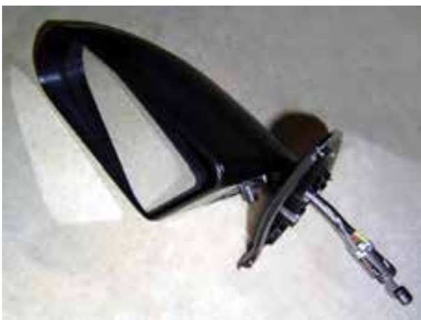
شکل ۱۵۶-۲- آینه‌ی جانبی و مکانیزم حرکت آن
