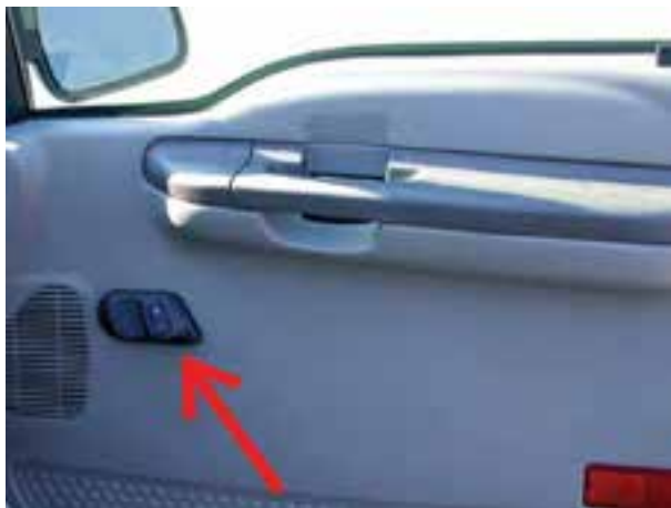
شکل ۱۳۲-۲- سوئیچ شیشه بالابر
