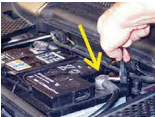
شکل ۱۴۱-۲- باز کردن کابل اتصال بدنه‌ی باتری
