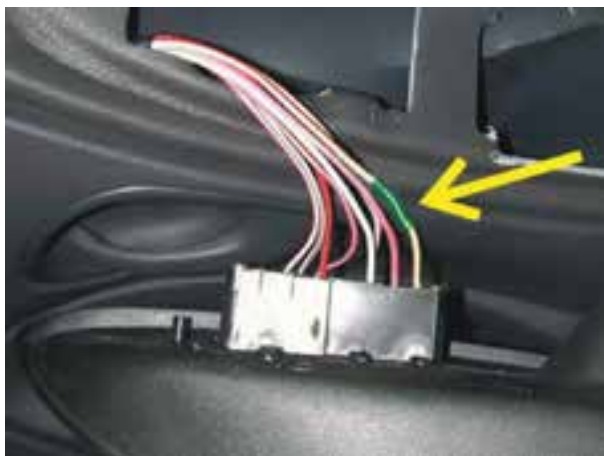
شکل ۱۵۳-۲- عایق‌کاری محل اتصال سیم قطع شده
