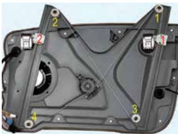
شکل ۱۰۶-۲- نحوه‌ی ارتباط رگلاتورهای مکانیزم شیشه بالابر
