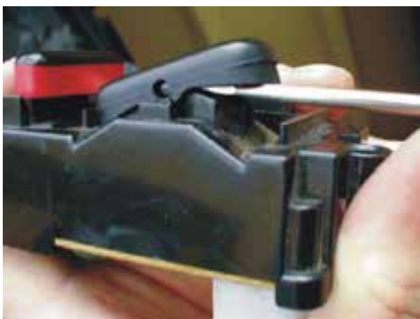
شکل ۲-۱۴۵- تعویض شستی معیوب
