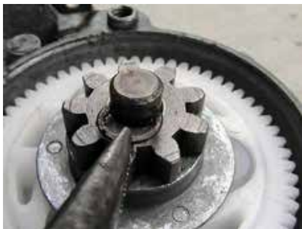
شکل ۱۲۹-۲ جانداختن خار فنری
