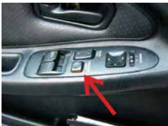
شکل ۱۳۷-۲- سوئیچ قفل کن سیستم شیشه بالابر
