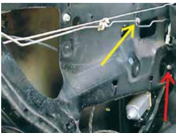
شکل ۱۱۶-۲- پیچ‌های اتصال شیشه بالابر به بدنه‌ی در
