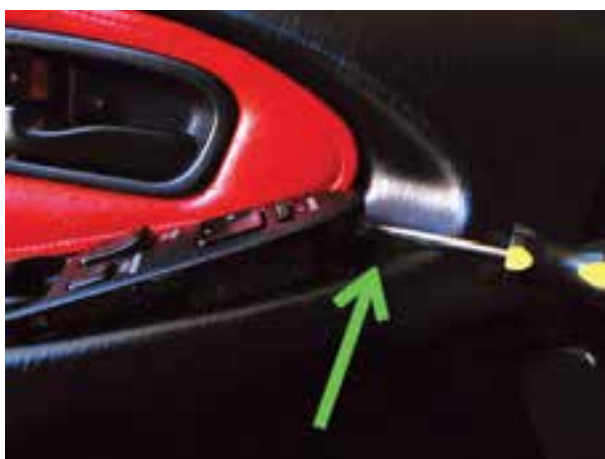
شکل ۱۴۲-۲- خارج کردن قاب سوئیچ شیشه بالابر
