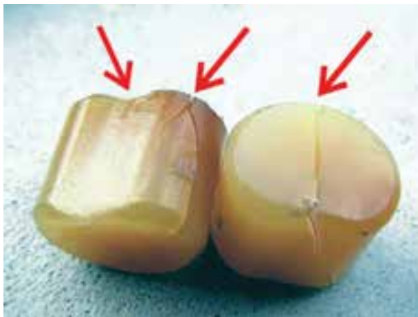
شکل ۱۲۶-۲- معیوب بودن بادامک‌ها
