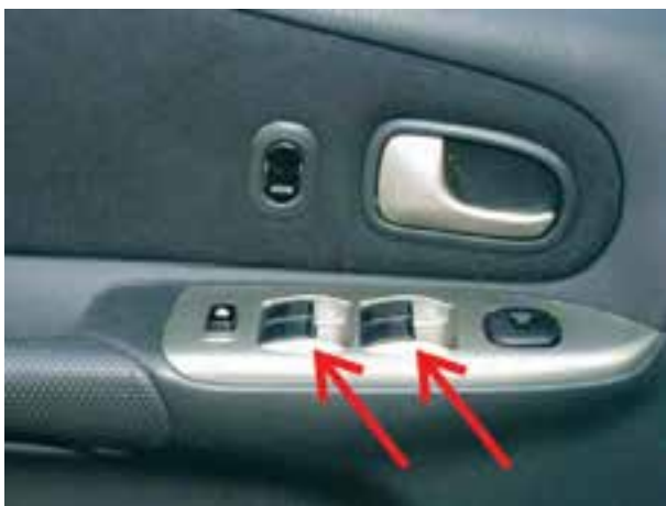
شکل ۱۳۵-۲- سوئیچ های شیشه بالابر در سمت راننده
