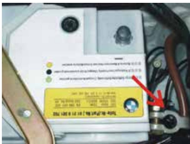
شکل ۱۰۹-۲- باز کردن اتصال منفی باتری
