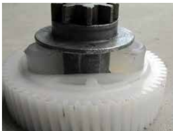
شکل ۱۲۸-۲ سوار کردن چرخ دنده‌ی فلزی
