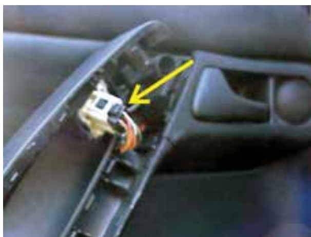
شکل ۱۱۱-۲- سوکت سوئیچ شیشه بالابر
