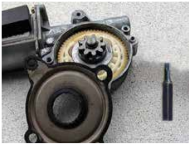
شکل ۱۲۴-۲- اجزای داخل جعبه دنده‌ی تعدیل دور
