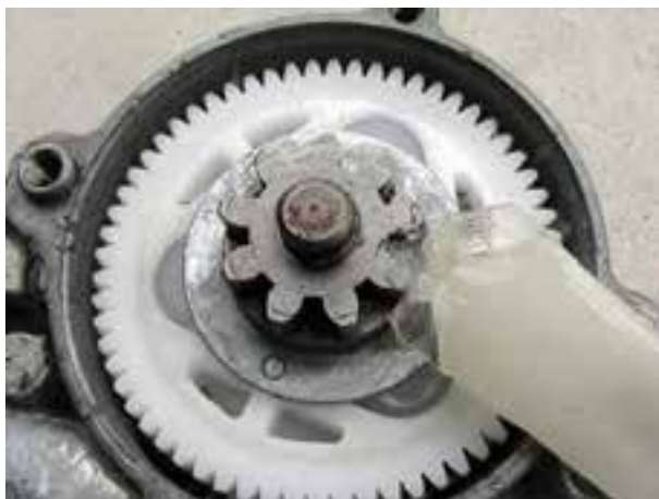
شکل ۱۳۰-۲- روغن کاری چرخ دنده ها
