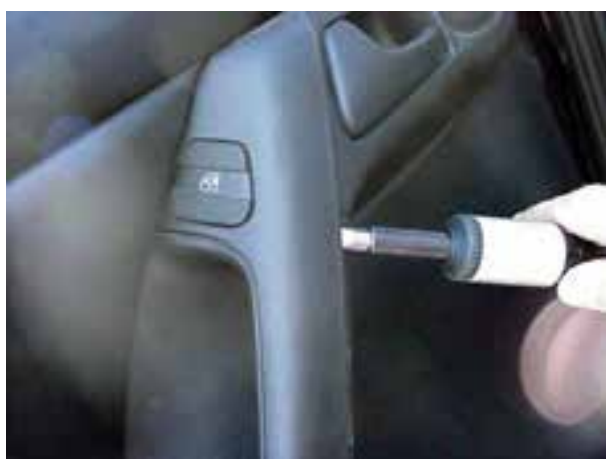
شکل ۱۱۰-۲- جدا کردن قاب سوئیچ شیشه بالابر
