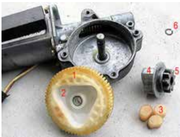
شکل ۱۲۵-۲- اجزای داخل پوسته‌ی گیربکس تعدیل دور
