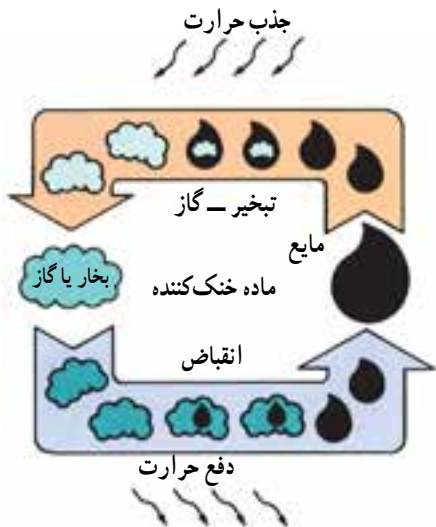
شکل ۵-۳- مراحل تغییر ماده خنک کننده
