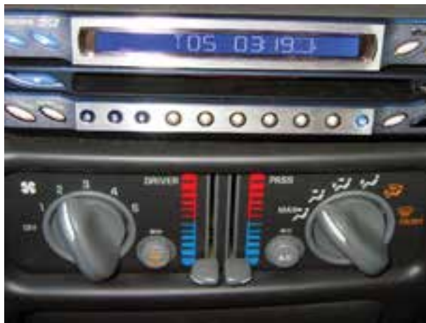
شکل ۲۳-۵- سوئیچ راه‌انداز فن کولر
