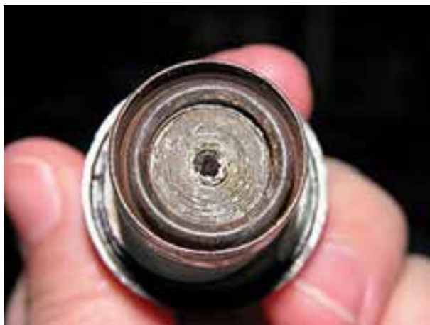
شکل ۱-۲۲۵- المنت حرارتی داخل سوئیچ فشاری
