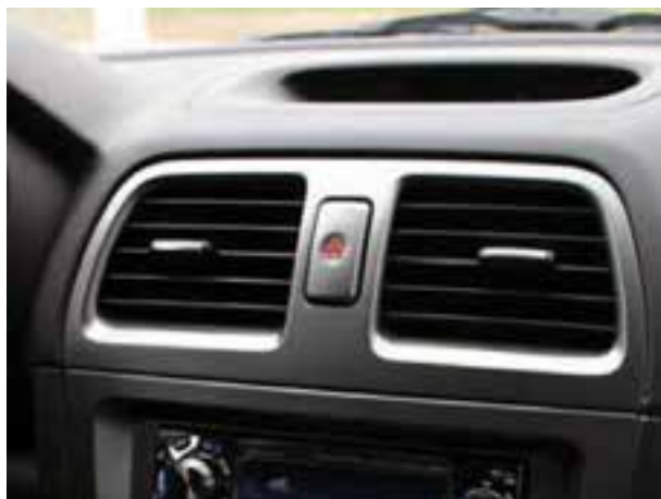
شکل ۱-۱۷۳- سوئیچ فلاشر یک‌نوع خودرو
