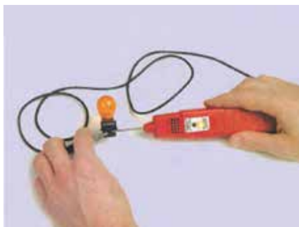
شکل ۱۸۲-۱- آزمایش لامپ چراغ راهنما
