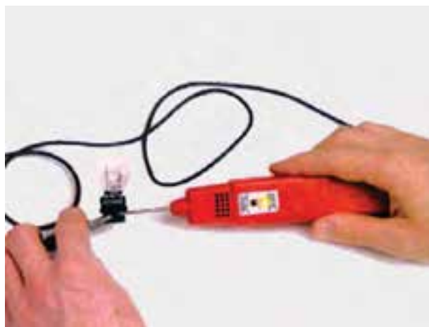
شکل ۲۱۹-۱- آزمایش لامپ چراغ صندوق عقب خودرو
