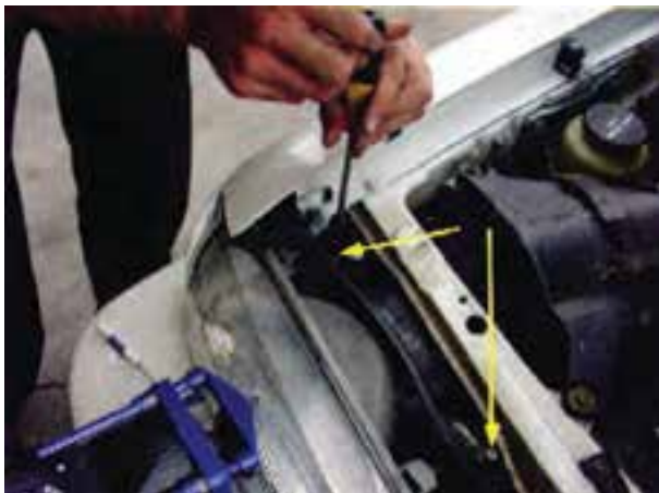
شکل ۱۶۷-۱- پیچ‌های تنظیم چراغ بزرگ جلو
