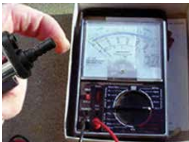
شکل ۱۹۶-۱- آزمایش سوئیچ لای در
