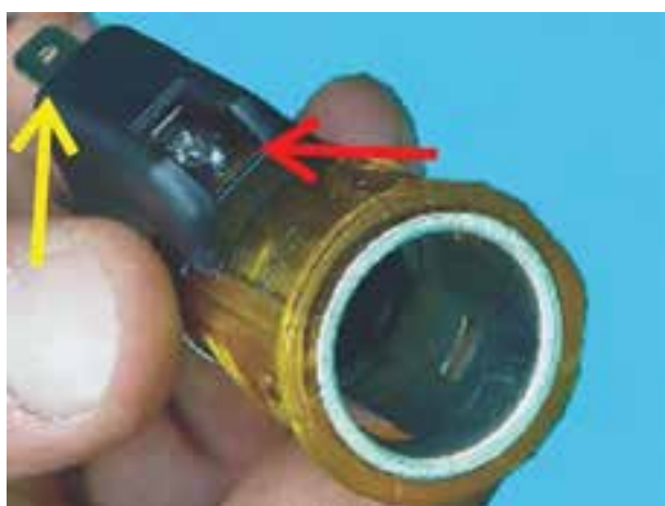
شکل ۱-۲۲۴- لامپ فندک و ترمینال الکتریکی آن
