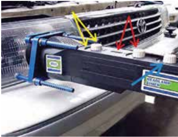
شکل ۱۶۱-۱- پیچ‌های تنظیم دستگاه تنظیم نور چراغ‌ها
