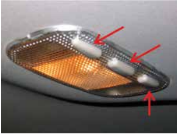
شکل ۱۸۶-۱- چراغ نقشه‌خوانی خودرو و کلیدهای آن
