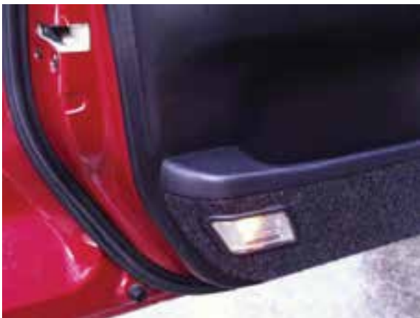
شکل ۱۸۷-۱- چراغ روی در خودرو
