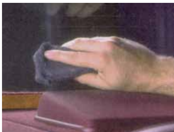
شکل ۳-۲۲- تمیز کردن محل قطع شده‌ی المنت حرارتی
