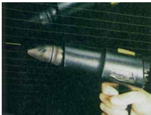
شکل ۳-۲۷ – حرارت دادن محل تعمیر
