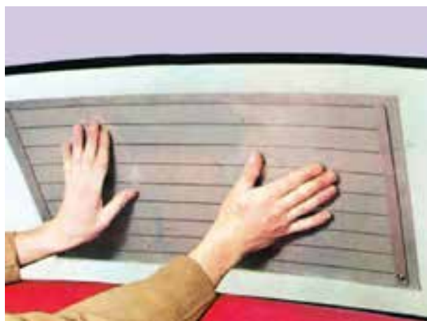
شکل ۳-۹- نحوه چسباندن المنت حرارتی
