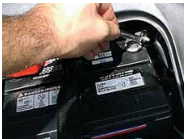
شکل ۳-۱۲- بستن کابل اتصال بدنه‌ی باتری
