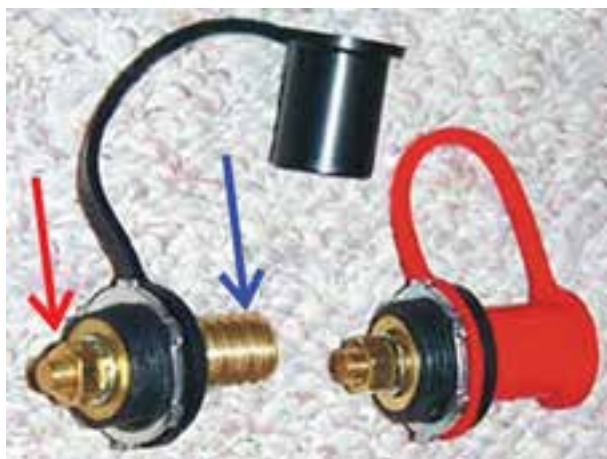
شکل ۱۴-۲- واسطه‌ی اتصال ترمینال باتری
