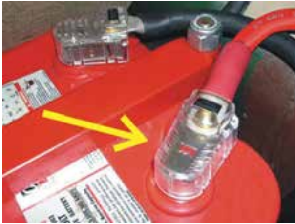
شکل ۱۹-۲- مورد استفاده تلق محافظ قطب‌های باتری
