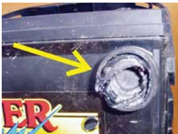
شکل ۳۶-۲- معیوب بودن ترمینال باتری
