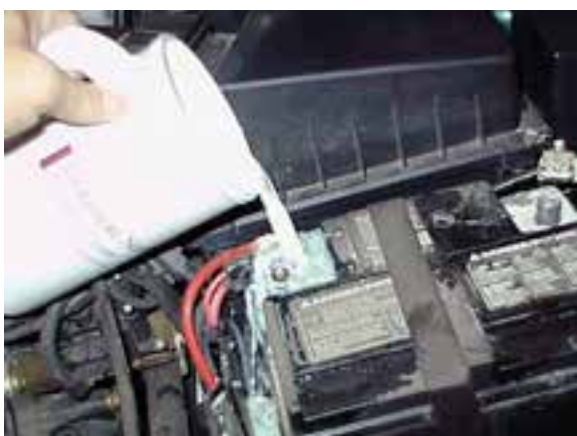
شکل ۲-۳۵ تمیز کردن سولفات سرب ترمینال باتری با محلول جوش شیرین
