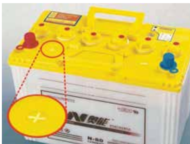
شکل ۲-۹- کاربرد علائم برای تشخیص قطب‌های باتری
