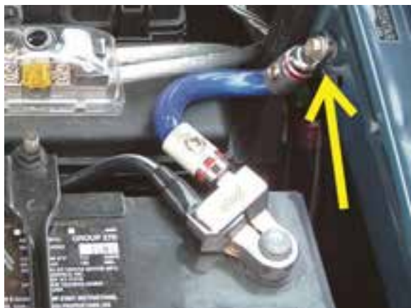
شکل ۲-۲۴ اتصال کابل منفی باتری به بدنه
