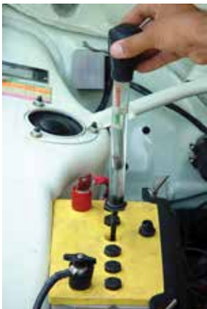
شکل ۱-۲۴- مورد استفاده‌ی هیدرومتر برای اندازه‌گیری غلظت چگالی مایع الکترولیت باتری
