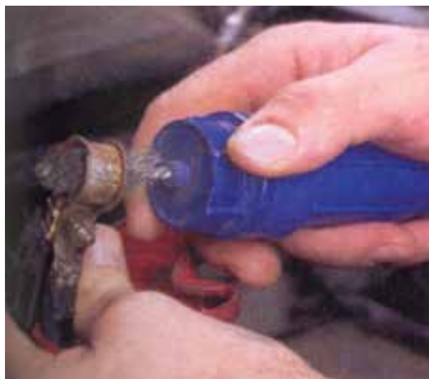
شکل ۹۱-۱ - پاک کردن بست‌های باتری با برس سیمی
