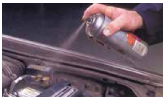
شکل ۱-۹۶- پاشیدن محلول ضد خوردگی روی بست
