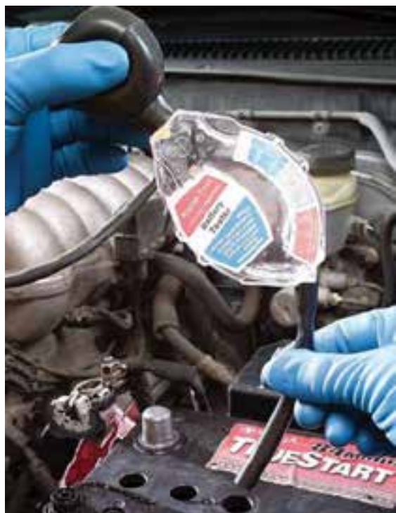
شکل ۱-۶۴- آزمایش چگالی الکترولیت داخل خانه‌های باتری
