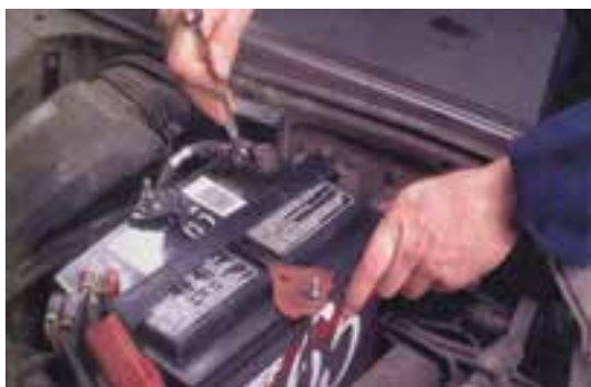
شکل ۱-۹۵- اتصال کابل‌های مثبت و منفی باتری
