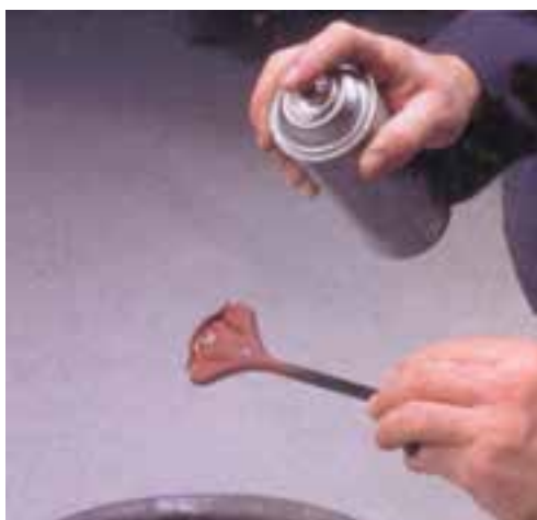
شکل ۹۳-۱- اسپری ضدخوردگی روی بست نگه‌دارنده‌ی باتری
