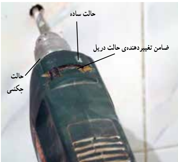
شکل ۲۱۲-۳ سوراخ کردن محل علامت‌گذاری شده
