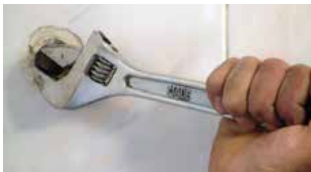
شکل ۱۹۸-۲- باز کردن درپوش‌ها
