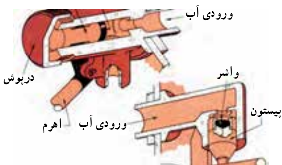
شکل ۱۱۳-۲ - اجزای شیر شناور
