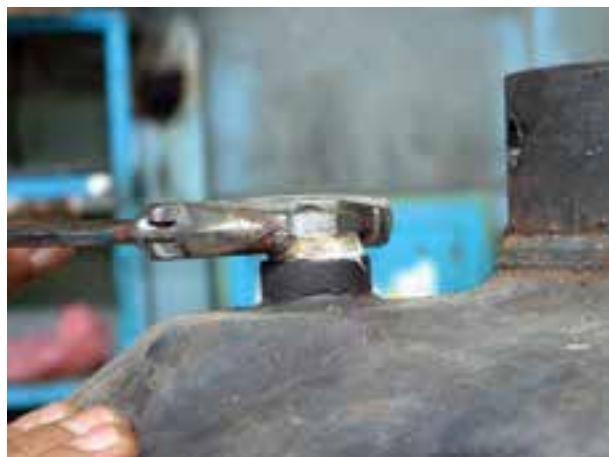
شکل ۱-۲۴- نحوه‌ی بازکردن میله‌ی منیزیم از محل خود
