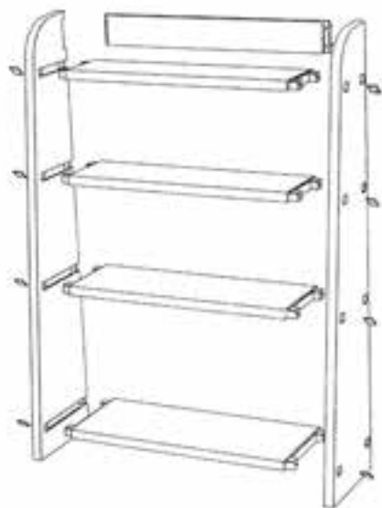
شکل (۵-۲۶) تصویر مجسم انفجاری کابینت طبقه‌بندی ماسیو کاربرد اتصالات گوشه‌ای و میانی کم و زبانه کوله‌دار مخفی و کم و زبانه‌های متوالی
