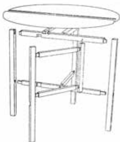
شکل (۵-۲۴) تصویر مجسم انفجاری میز با صفحه دو تکه کاربرد اتصالات گوشه‌ای کم و زبانه کوله‌دار و کم
