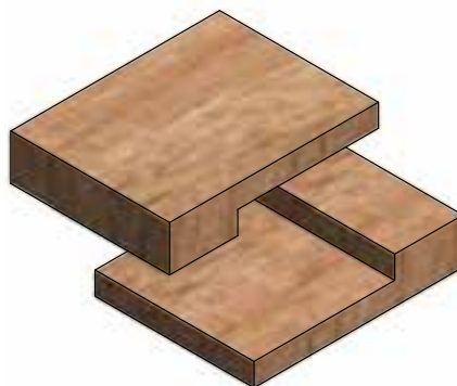
شکل (۵-۵۱) طریقه رسم اتصال طولی نیم و نیم باله‌های مرتب در نماها و تصویر مجسم
