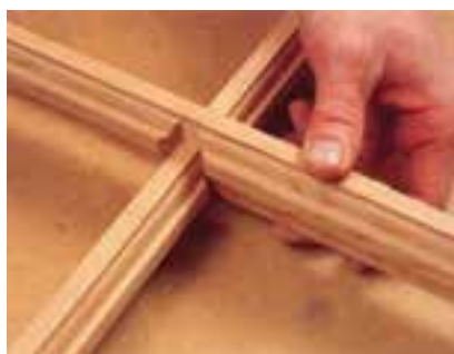
شکل (۵-۹۷) تصویر مجسم اتصال متقاطع در حال جازدن
