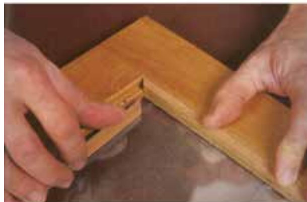
شکل (۵-۴۱) تصویر مجسم انفجاری اتصال گوشه قاب و اتصال آن
