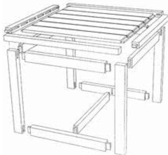
شکل (۵-۲۷) تصویر مجسم انفجاری میز کار با چوب ماسیو کاربرد اتصالات گوشه‌ای و میانی کم و زبانه کوله‌دار مخفی و کم و زبانه‌های متوالی
