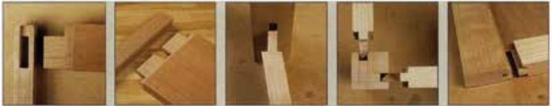
اتصال کُم و زبانه کوله دار اتصال کُم و زبانه دوزبانه اتصال کُم و زبانه کج کُم و زبانه کوله دار قید به پایه مبلمان شکل (۲-۵) موارد ۶ تا ۱۰
