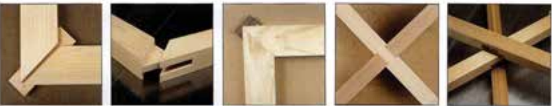
اتصال متقاطع اتصال دور و فارسی اتصال دور و فارسی با زبانه جدا موازی فارسی اتصال فاق و زبانه دور فارسی اتصال دور و فارسی با زبانه جدا (قلیف) شکل (۴-۵) موارد ۱ تا ۵
