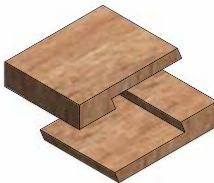
شکل (۵-۵۲) طریقه ترسیم اتصال طولی نیم و نیم ساده در نماها و تصویر مجسم
