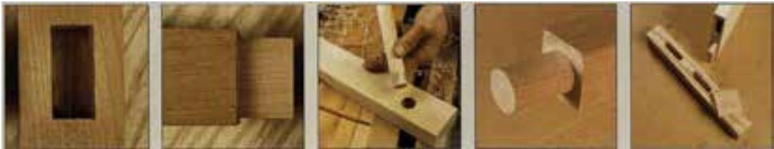
اتصال کُم و زبانه اتصال کُم و زبانه جدا اتصال دبل سر خود اتصال کُم و زبانه جدا شکل (۱-۵) موارد ۱ تا ۵
