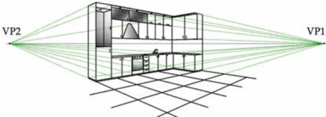
شکل ۲-۴۱ پرسپکتیو دو نقطه‌گریز
