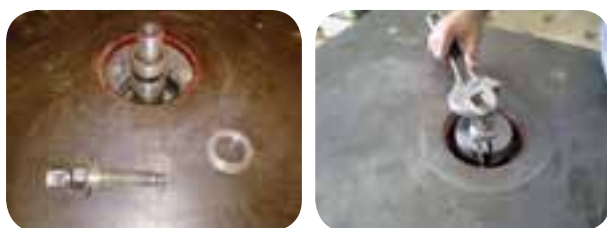
شکل ۲-۲۸ تنظیم کردن توپی در دستگاه فرز
