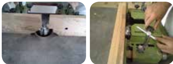
شکل ۲-۲۹ الف بستن حفاظ ها
