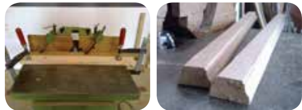
شکل ۲-۳۰ چوب ابزار خورده، ابزار زدن قطعه کار
