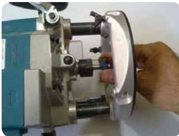
بستن تیغه در داخل دستگاه
