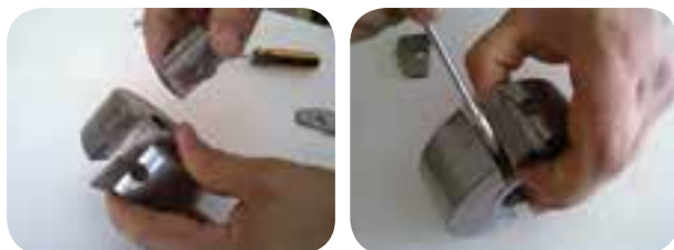
شکل ۲-۲۷ تنظیم و محکم کردن تیغه داخل توپی
