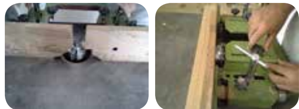
شکل ۲-۳۱ الف تنظیم اره فارسی بر
