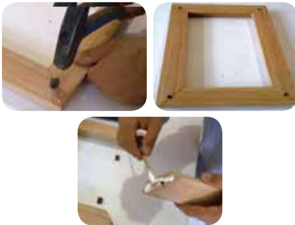
شکل ۲-۳۳ مراحل متصل نمودن قطعات قاب
