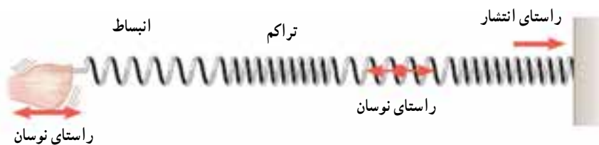
شکل ۱۰-۴- انتشار موج طولی در فنر
