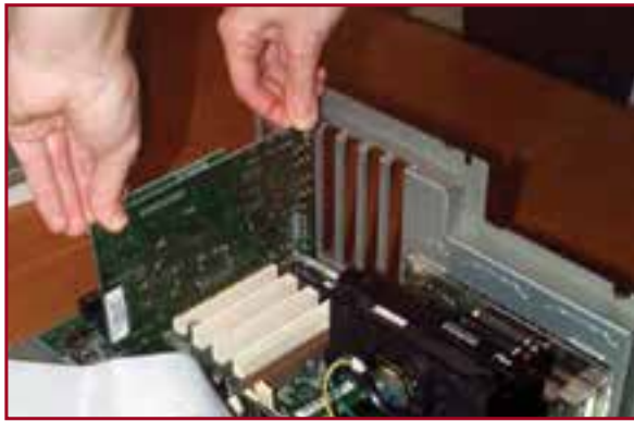
شکل ۵-۶- قرار دادن کارت توسعه در یکی از شیارهای توسعه
