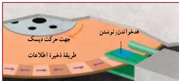
شکل ۱-۸ - نحوه ذخیره سازی در دیسک مغناطیسی
