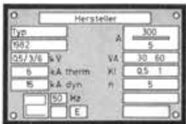
شکل ۵-۶۷- تابلوی مشخصات ترانسفورماتور جریان
