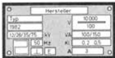
شکل ۵-۶۹- پلاک مشخصات ترانسفورماتور ولتاژ
