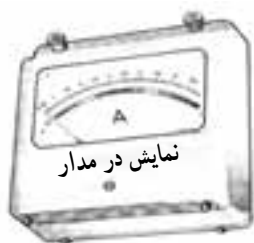
شکل ۲۹-۵ شکل ظاهری آمپر متر
