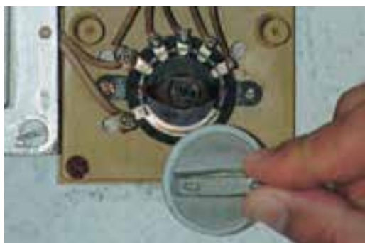
شکل ۷-۳۷۶ سیم رابط فاز خروجی کلید به پنکه
