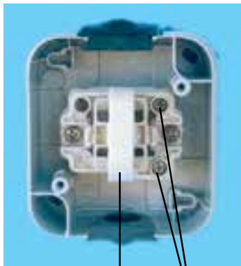
اهرم قطع و وصل الکلنگی ترمینال‌های ورودی و خروجی
