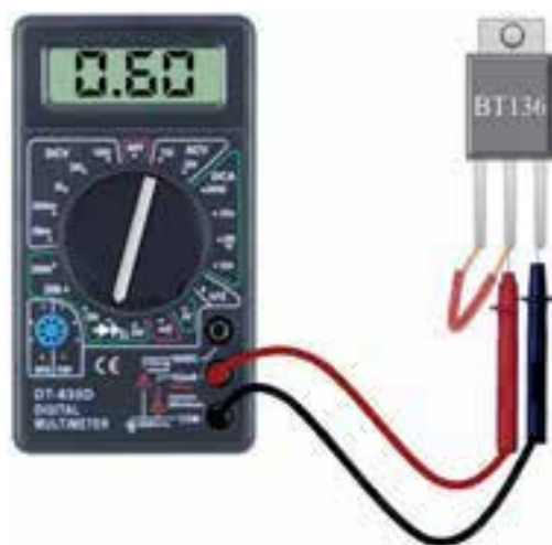
شکل ۱۷-۳- روشن کردن ترایستور توسط مولتی‌متر
