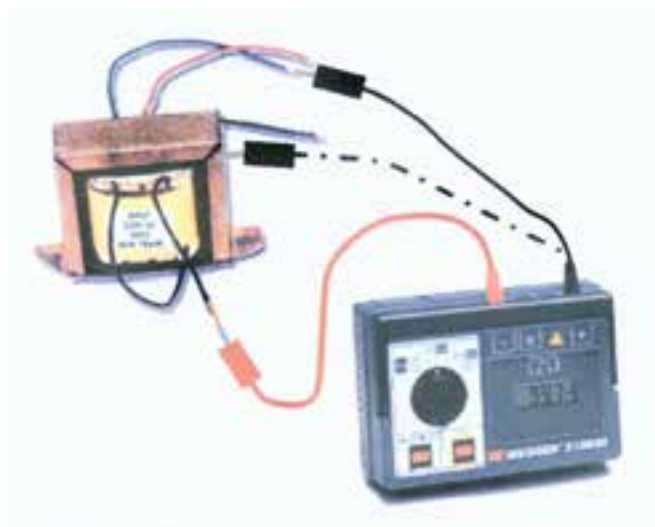
شکل (۲۶-۳) تست عایقی
