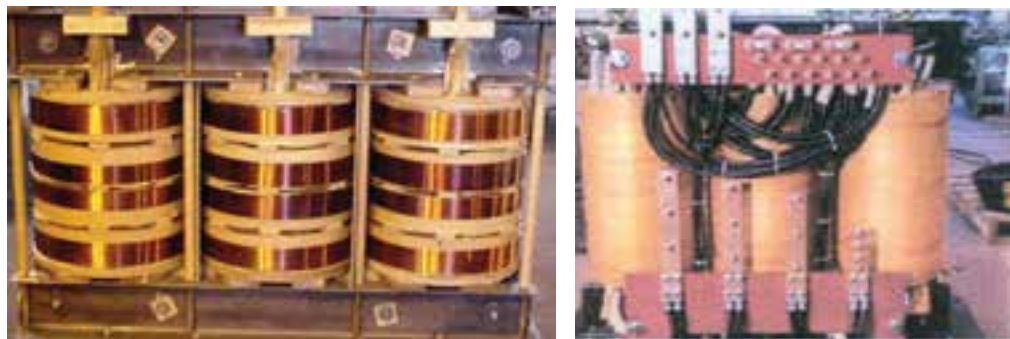
شکل(۳-۲۳) در سیم پیچ های سالم رنگ تمام قسمت ها یکنواخت و شفاف است
