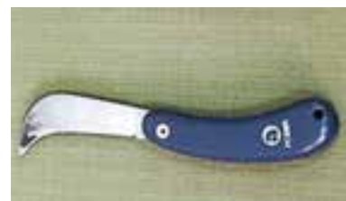
شکل (۱-۳۰) چاقوی مخصوص روپوش برداری کابل
