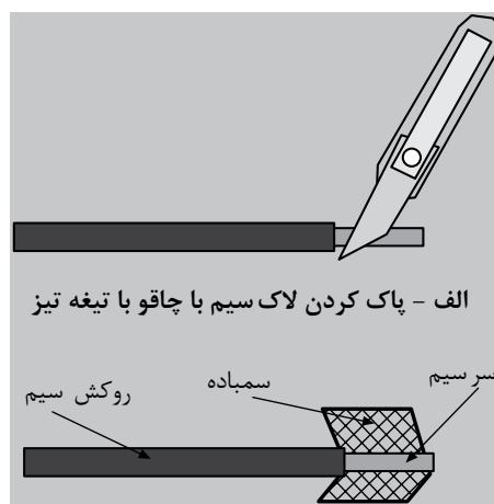
شکل (۱-۵) پاک کردن لاک سیم با سمباده
