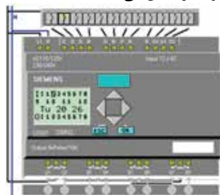
اتصال موقت به طریق ترمینال‌ها
