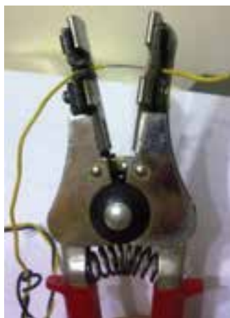
شکل (۱-۴) برداشتن روکش سیم‌ها
