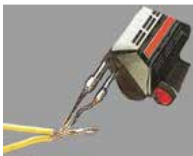
شکل (۱-۳) اتصال لحیم کاری نرم
