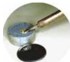
د- تمیز کردن سر هویه
