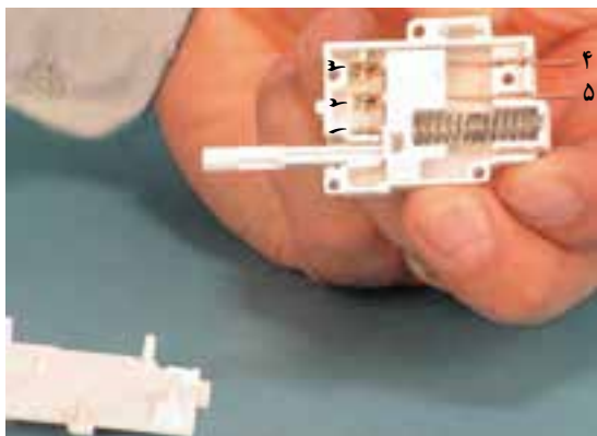
شکل ۳-۳۲ - میکروسوییچ S_2 در حالت عادی
