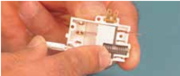
شکل ۳-۳۵ - میکروسوییچ S_1 در حالت تحریک
