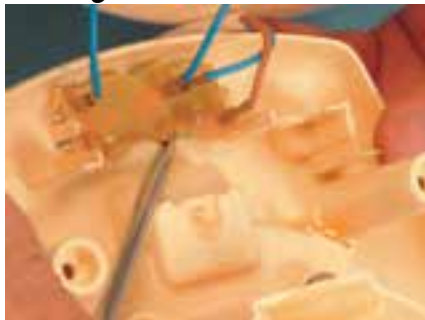
ب - پلاتین‌ها در حالت وصل
