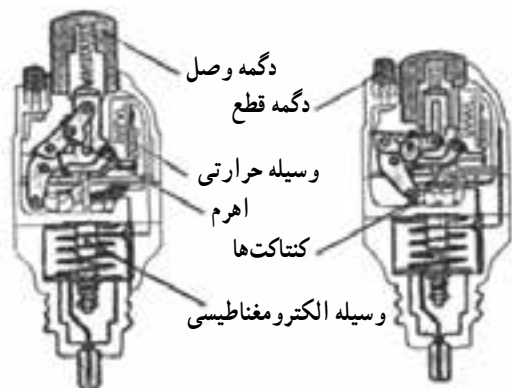
شکل ۱-۶ - ساختمان داخلی فیوز آلفا
