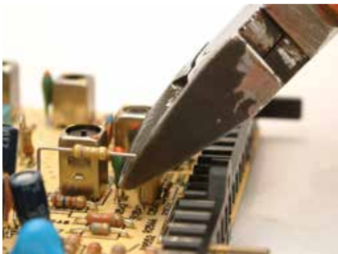
شکل ۲۹-۲- قطع کردن پایه بلند المان‌ها برای ایجاد عیب
