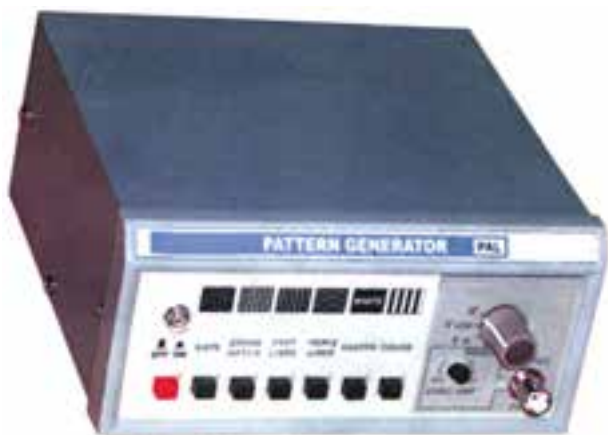
شکل ۲-۲۶- نمونه ای از دستگاه پترن ژنراتور
