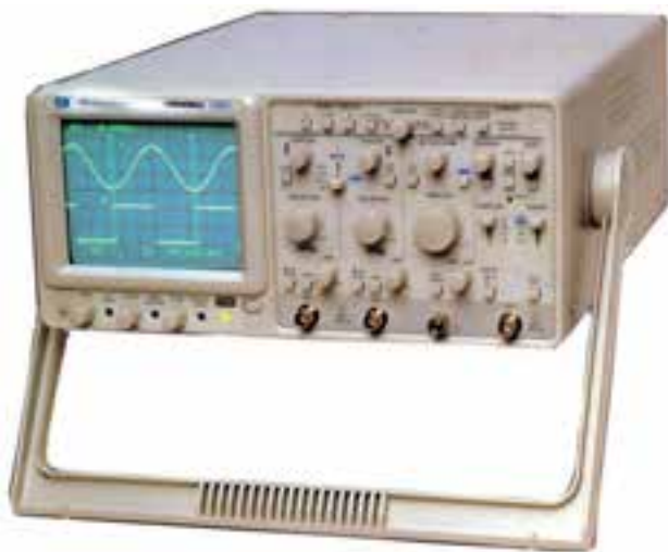
شکل ۲-۲۵- یک نمونه اسیلوسکوپ
