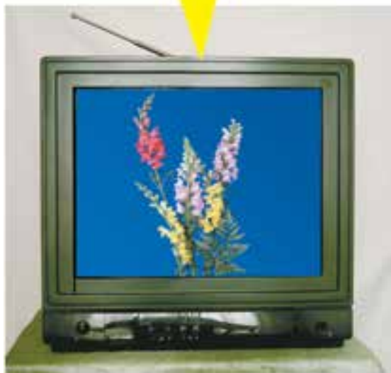
شکل ۲-۳۳- تلویزیون باید بعد از تعمیر مدتی روشن نگه داشته شود.
