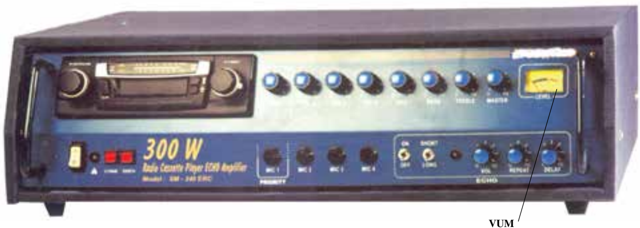
شکل ۱-۳- ابزار سنجش VUM در یک آمپلی فایر
