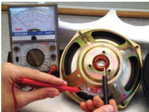
شکل ۱-۳۹ - اندازه‌گیری مقاومت بلندگو
