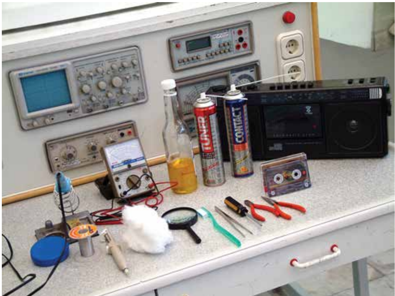
شکل ۱-۱۹- دستگاه ضبط صوت، پیچ گوشتی، دم باریک، پنس
