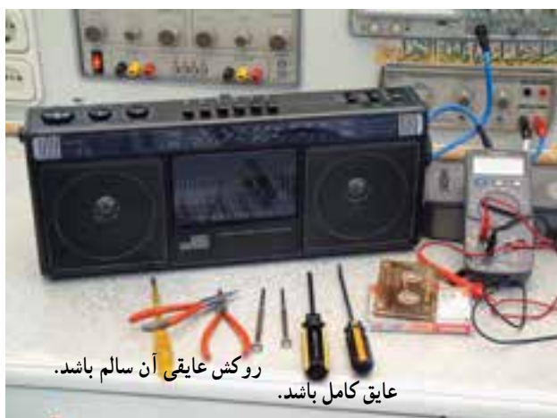
شکل ۱-۱۰ وسایل و ابزار مخصوص تعمیرات الکترونیکی
