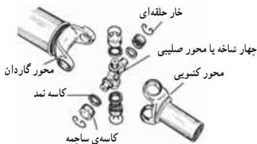
شکل ۲۹۱- اجزای قفل گاردان
