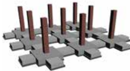
شکل ۲-۱۸- پی کلاف شده
