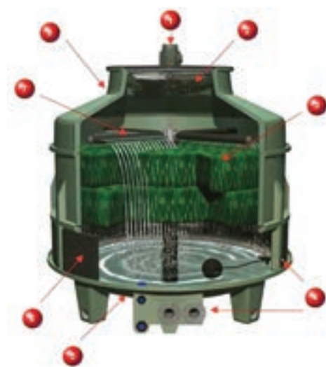
شکل ۸-۴- برج خنک کن
