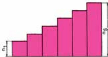
شکل ۱-۱- نمودار دستگاه انتقال حرکت پله‌ای
