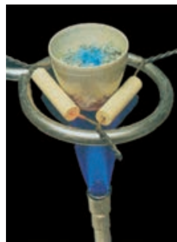
شکل ۳۱. گرم شدن کات کبود و از دست دادن آب تبلور
