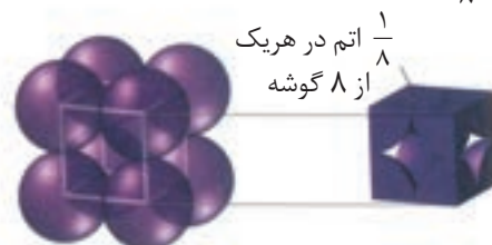
شکل ۱۶. نمایش یک سلول واحد مکعبی ساده و سهم اتم ها در آن
