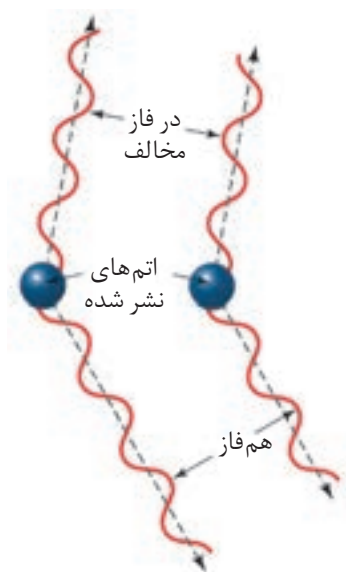
شکل ۳۰. هم‌فاز و ناهم‌فاز بودن پرتوهای X نشر شده از اتم‌ها
