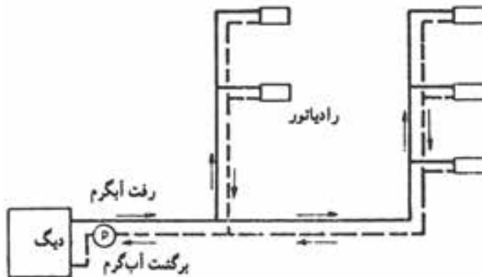
▲ شکل ۳-۹- حرارت مرکزی با آب گرم
