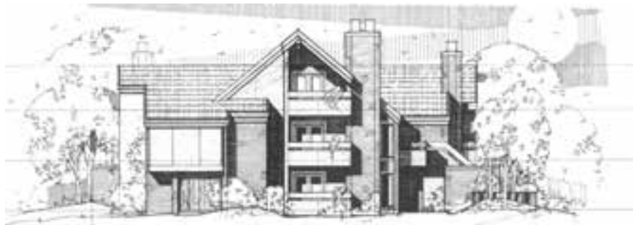
شکل ۲-۴۰- ارائه‌ی نما با استفاده از سایه روشن نما و بافت مصالح
