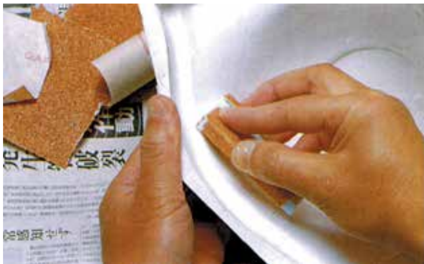
۱۳- زبریه‌های سطح قالب گچی را پس از خشک شدن گچ با سنباده برطرف کنید.
