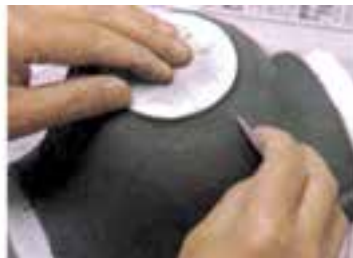
۸- با یک کاردک پلاستیکی دارای انحنای، سطح مدل را صاف کنید.
