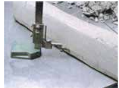
۴- برای اطمینان از تراز بودن خطوط روی مدل از وسیله‌ای شبیه آنچه در شکل آمده است استفاده می‌شود. (کولیس پایه‌دار)
