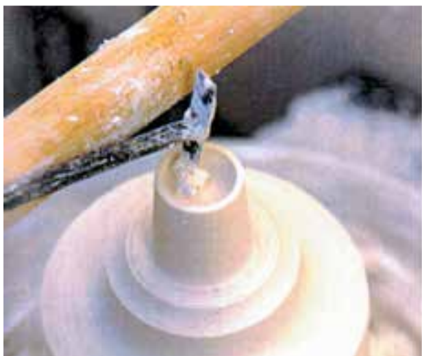
۸- تراش داخلی با استفاده از تکیه‌گاه
