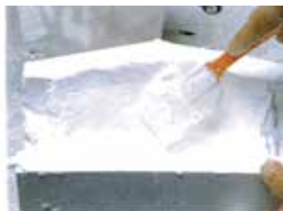
۱۶- گچ را درون قالب یک دست کنید.
