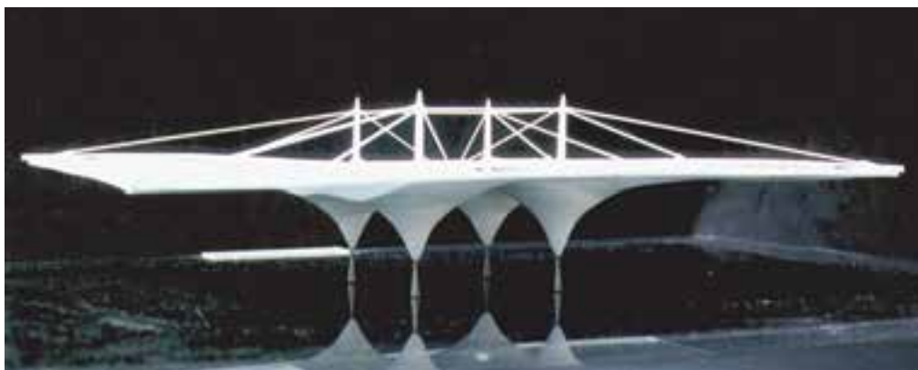
شکل ۳۲- مدل پوسته‌ای با فایبرگلاس
