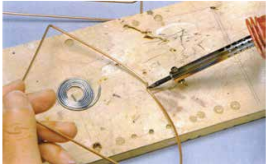
۴- در جاهایی که نیاز است از لحیم کاری استفاده می‌شود.
