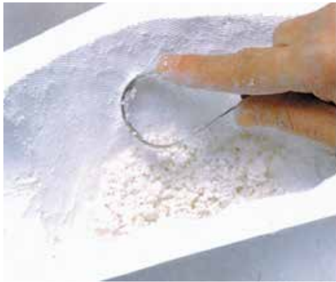
۱۸- قبل از آن که گچ به طور کامل سفت شود با تیغه ای کمانی شکل و دنداندار، سطوح ناخواسته را بتراشید.
