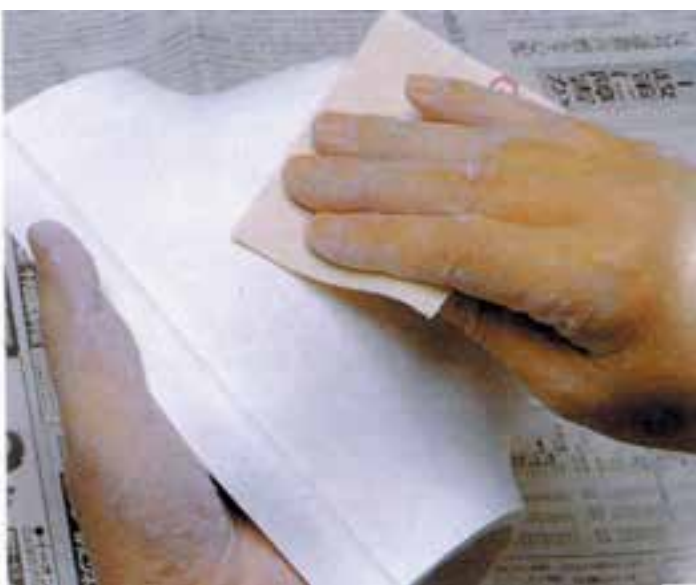
۱۸- قبل از آن که گچ به طور کامل سفت شود با تیغه ای کمانی شکل و دنداندار، سطوح ناخواسته را بتراشید.
