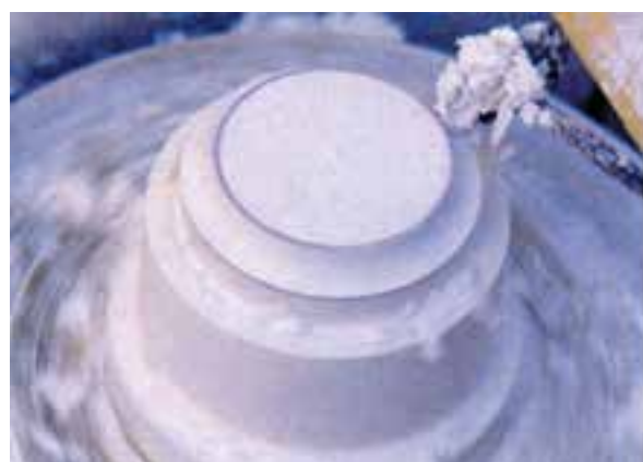
۱۱- ساخت یک پایه برای ایجاد یک مدل روی آن و آغاز مرحله سوم
