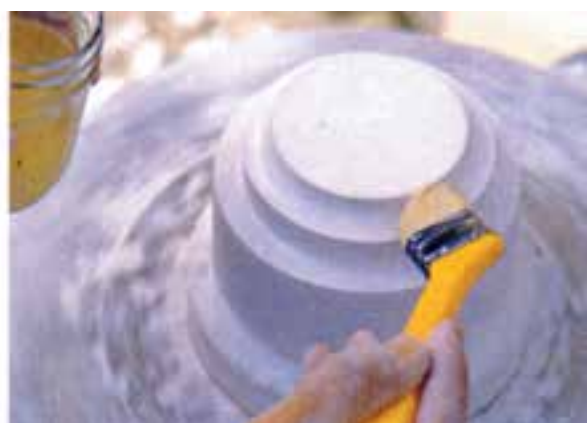
۱۲- مرحله زدن مایع جدا کننده برای گذاردن گچ روی پایه ساخته شده
