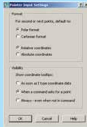
بدین ترتیب، همان گونه که در فصل قبل ملاحظه شد، وقتی پیش فرض بر روی مختصات نسبی قرار بگیرد، برای ورود اعداد مختصات، به قرار دادن علامت @ در ابتدای آن نیاز نیست. در بخش Visibility شرایط نمایش مختصات فعلی نشانگر ماوس تعیین می‌شود. در واقع کاربر تعیین می‌کند که در چه زمان‌هایی مختصات ماوس در کنار آن نمایش داده شود؛ به شرح زیر:
