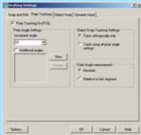
در بخش Polar Angle Settings زاویه‌ای پیش‌فرض در پنجره‌ی Increment angle تعیین می‌شود که وقتی  $90^\circ$  باشد راستاهای افقی و عمودی را شامل می‌شود. اگر کاربر بخواهد زوایای دیگری را به این مکان اضافه نماید، باید گزینه‌ی Additional angles را فعال نماید و با کلیک بر دکمه‌ی New، زوایای جدید را در آن تایپ کند. در صورت نیاز به حذف هر کدام از زوایای اضافی، آن را انتخاب و از دکمه‌ی Delete استفاده می‌کند.
