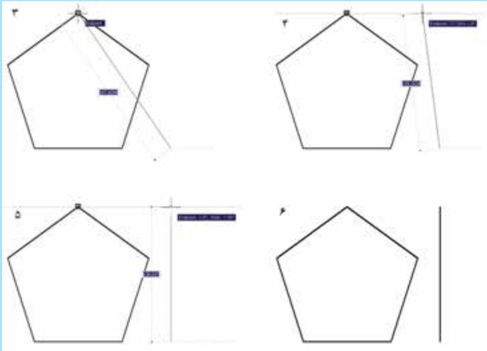
تنها تنظیم مربوط به ردیابی اشیا در کنار تنظیمات ردیابی قطبی قرار دارد. در این جا اگر به جای گزینه‌ی Track orthogonally only، گزینه‌ی Track using all polar angle settings را انتخاب کنیم، به جز راستاهای افقی و عمودی، کلیه‌ی راستاهایی که زاویه‌ی آن‌ها در ردیابی قطبی تعیین گردیده‌اند نیز به ردیابی امتداد اشکال اضافه می‌شود.
