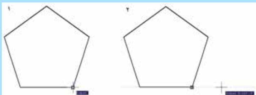
با تعیین نقطه‌ی اول خط، ماوس را به رأس فوقانی پنج ضلعی نزدیک و Endpoint آن را تعیین می‌کنیم. سپس ماوس را به بیرون از پنج ضلعی حرکت می‌دهیم تا خط چین راستای رأس بالایی آن نیز نمایان شود. حال اگر ردیابی قطبی نیز فعال باشد می‌توانیم به دو خط چین دست یابیم که یکی حاصل ردیابی اشیا برای پنج ضلعی و دیگری حاصل ردیابی قطبی راستای عمودی خط ترسیمی است.
