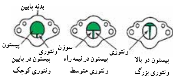
شکل ۹-۹- اجزای کاربراتور و نتوری متغیر
