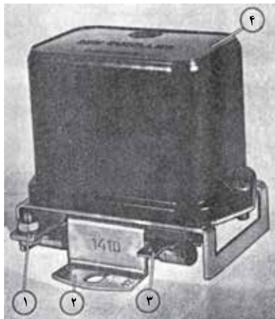
شکل ۱۵-۸ - ساختمان ظاهری تنظیم کننده برق
