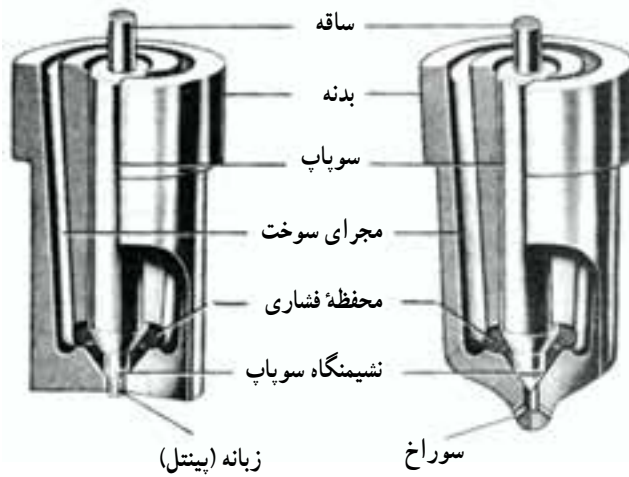
شکل ۱۹-۵ - قسمت‌های مختلف افشانک: نوع سوراخ‌دار (سمت راست)، و نوع زبانه‌ای یا پینتل (سمت چپ)
