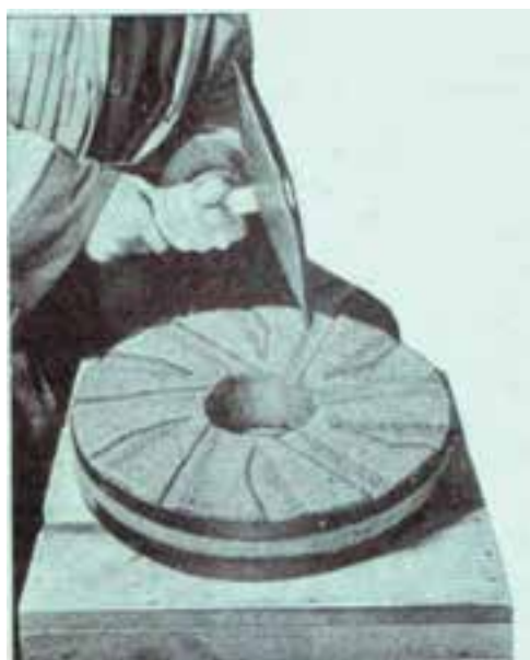
شکل ۳۹-۳- ایجاد شیار روی سنگ آسیا
