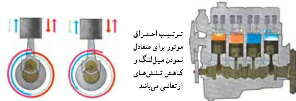
شکل ۲۱-۳- تایمینگ سوپاپ‌ها و زمان کار موتور
