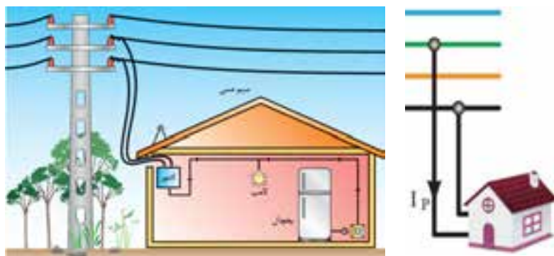
شکل ۹-۱ نحوه‌ی اتصال برق منازل مسکونی
