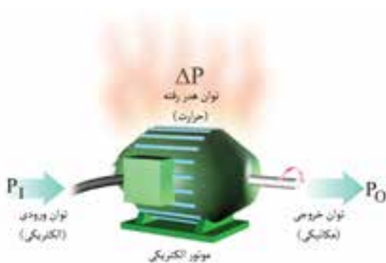
شکل ۵۴- ۱ توان و تلفات در موتور الکتریکی
