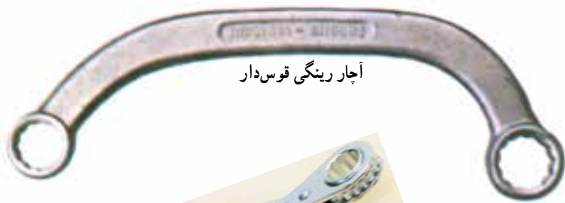
آچار مخصوص برای کار روی رابط‌های مسی یا برنجی
