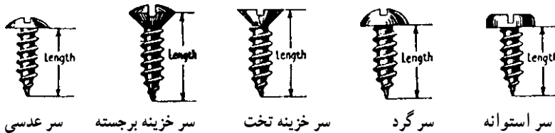
شکل ۱-۴۵ - انواع پیچ خودرو برای اتصالات فتری
