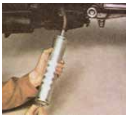
شکل ۳۹-۱- روش پر کردن گیربکس
