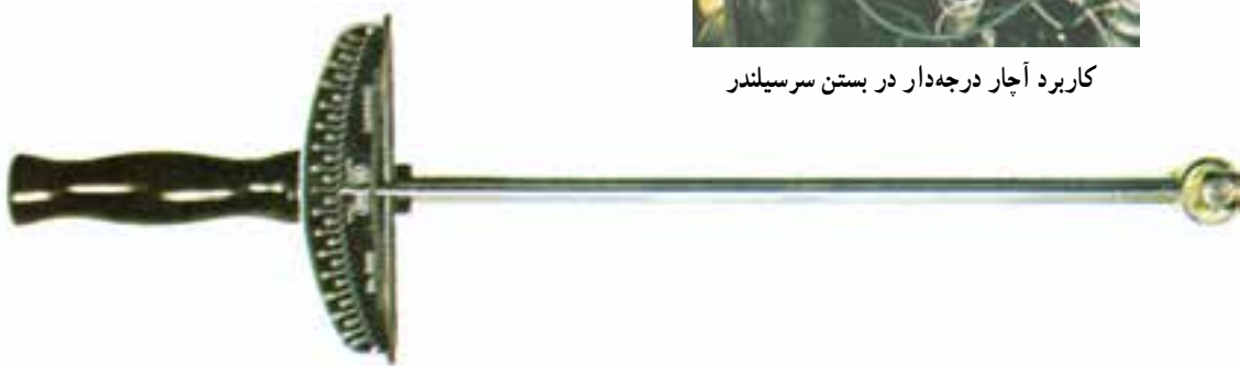
شکل ۸-۱ آچار درجه‌دار و کاربرد آن
