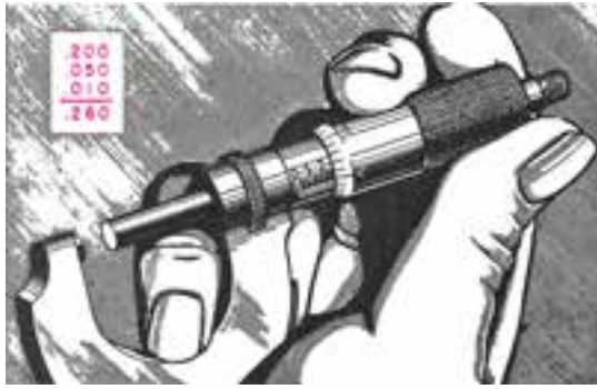
شکل ۱-۵۴- روش به دست گرفتن میکرومتر
