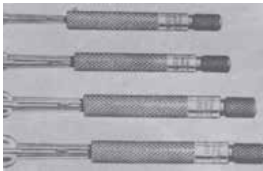
شکل ۱-۵۹- اندازه‌گیر قطر سوراخها
