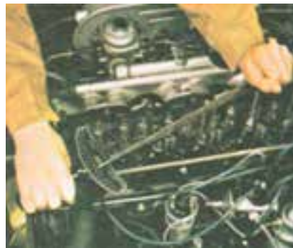
کاربرد آچار درجه‌دار در بستن سرسیلندر
