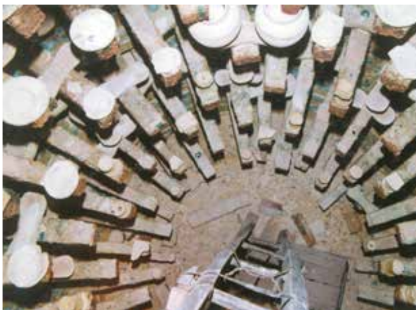
تصویر ۴- داخل یک کوره سنتی گازی
