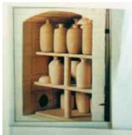
تصویر ۵- داخل یک کوره الکتریکی
