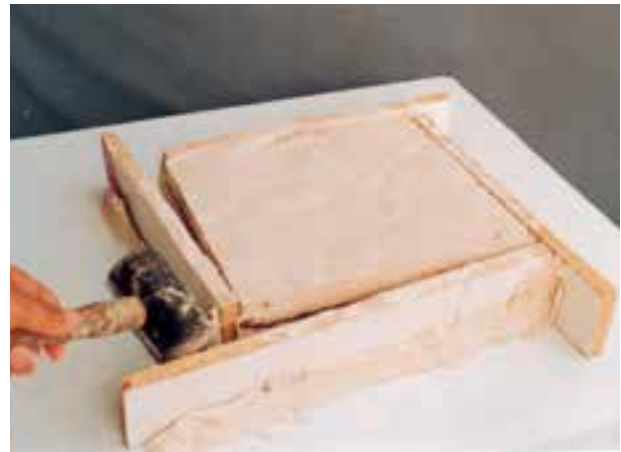
تصویر ۲- ه- جدا کردن دیواره‌ها
