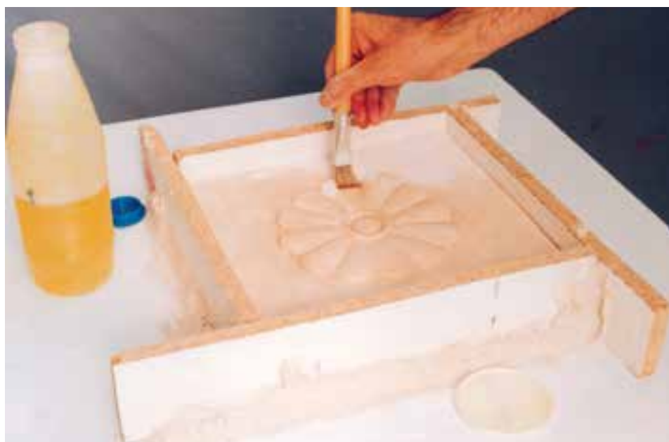
تصویر ۲- ب- آغشته نمودن سطوح داخلی دیواره و نمونه با مواد جداکننده
