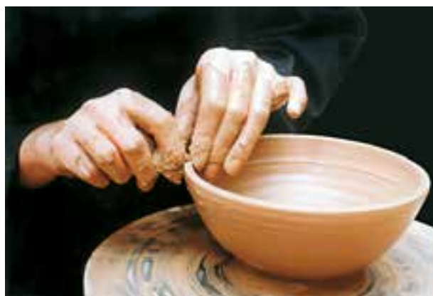
تصویر ۲۴- از بین بردن زوایای لبه کاسه
