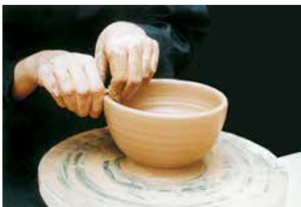
تصویر ۲۷- یکنواخت کردن لبه کاسه
