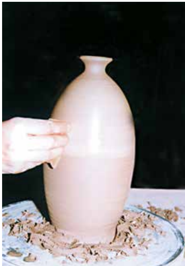
تصویر ۶۰- صاف کردن سطح بدنه با اسفنج
