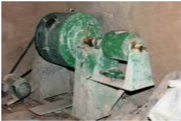
تصویر ۳- ب - آسیاب گلوله‌ای (بالمیل)
